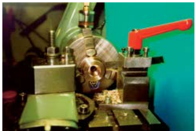
Standardwerkzeughalter mit Abstechstahl, befestigt auf Grundkörper, im Einsatz.
