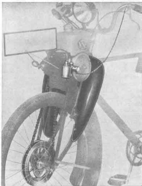
Serienmäßige Neuerungen am Motosulm: Stoßdämpfer, Kettenschutz, Starterklappe, Beinschutz
